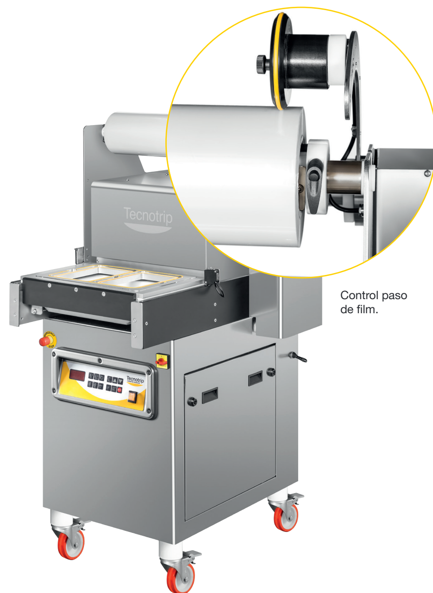
Sistema automático para la recogida del film sobrante, controlado mediante un sistema que permite el máximo aprovechamiento.
