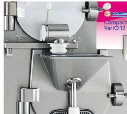
**Passaggio diretto** - La miscela pronta viene trasferita nel cilindro di mantecazione, attraverso il rubinetto esterno, facilmente smontabile e lavabile per la massima igiene.
