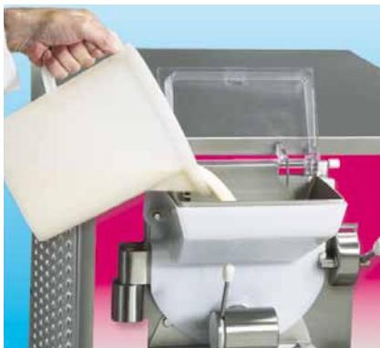
**Miscelatore orizzontale** - Si versano nella tramoggia del cilindro superiore gli ingredienti che vengono finemente miscelati. L'elevata velocità di rotazione permette la completa dispersione degli ingredienti secchi nella miscela.
