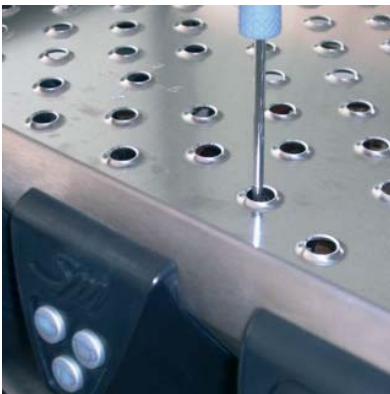
REGULACIÓN DE LA TEMPERATURA DEL CAFÉ Y DE LAS INFUSIONES DESDE EL EXTERIOR
