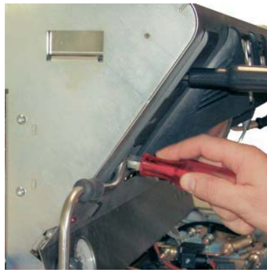
REGULACIÓN DE LA PRESIÓN DE LA CALDERA DESDE EL EXTERIOR
