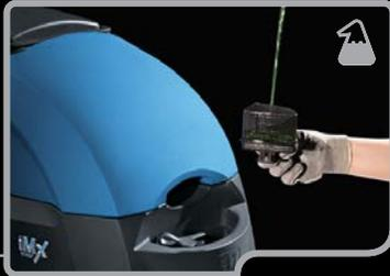
La tapa del tanque funciona también como dosador, y permite verter la correcta cantidad de detergente, evitando desperdicios o dosis excesivas
