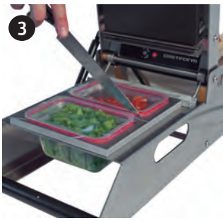
Corte El molde para 2 barquetas incluye ranura en el centro para facilitar el corte del film y separar las barquetas.
