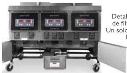
Detalle del sistema de filtro integrado. Un solo drenaje para las tres cubas.
