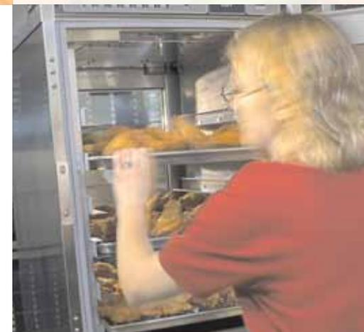
Los armarios calientes están diseñados para almacenar comida caliente y en perfectas condiciones durante largos periodos de tiempo. Trae incorporado relojes de cuenta atrás con 13 canales. Sus dos ventiladores les permiten circular el aire húmedo por todo el interior de la cavidad. Como opción tiene una gran bandeja recipiente de agua para ambientes más húmedos. Disponible en dos tamaños para acomodar cualquier necesidad.
